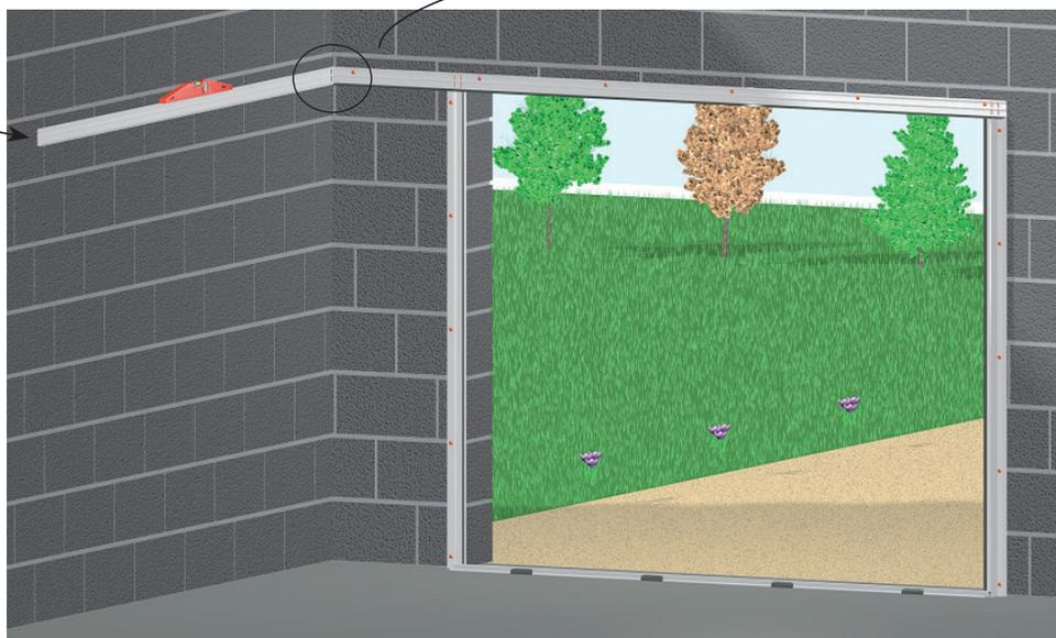
Positionner la traverse de niveau en alignement avec la traverse tableau
