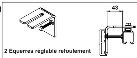
Positionner les équerres suivant les préconisations ci-dessous et bloquer les
