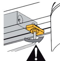
**!** Ne pas serrer la vis de fixation au maximum possible. Un serrage exagéré peut endommager la vis et conduire à une mauvaise tenue de la butée
