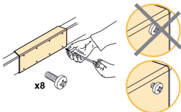
**!** Les vis de fixation ne doivent pas rentrer dans le rail ( ne pas percer ).
