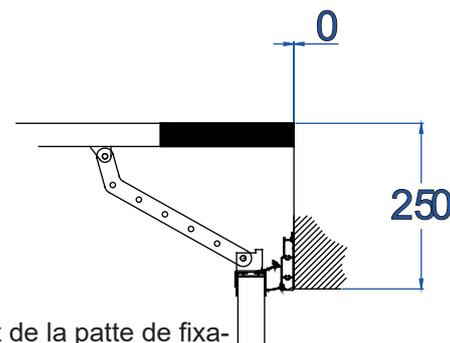
**!** Positionnement de la patte de fixation dans l'axe du panneau
