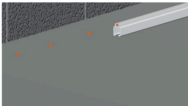
Insérer, à chaque extrémité des rails, la quantité d'écrou carré correspondant au nombre de pattes de fixation
